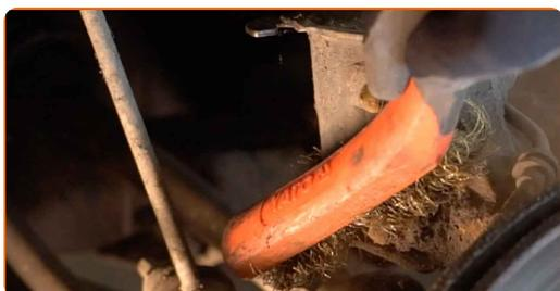
**15** Odpojte upevnenie ABS snímača a jeho kábla zo vzpery tlmiča.
