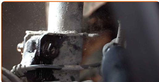
**16** Odskrutkujte spodný upevňovací prvok spájajúci vzperu tlmiča a hlavu ložiska čapu kola. Použite kombinačný kľúč č.18 Použite nástavec č.18. Použite vratidlo.
