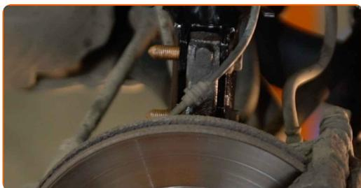
**40** Zaskrutkujte upevňovací prvok, ktorý spája tlmič k hlave ložiska čapu. Použite kombinačný kľúč č.18 Použite nástavec č.18.
