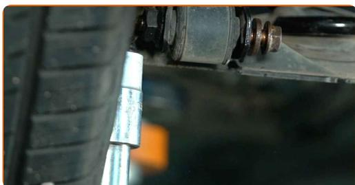
22 Utiahnite spodné upevnenie tlmiča. Použite nástavec č.14. Použite momentový kľúč. Utiahnite ju krútiacim momentom 48 Nm.
