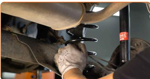
**18** Podprite nosník zadného odpruženia kolies. Použite zdvihák s hydraulickými prevodmi.
