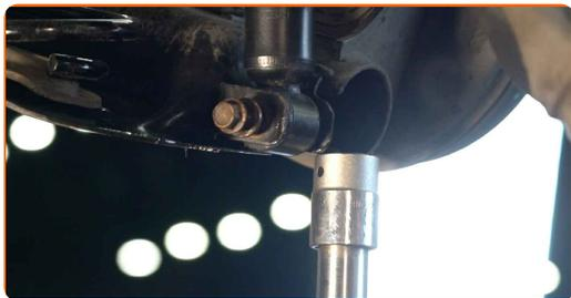
20 Odstráňte upevnenie spod nosníka zadnej nápravy.
