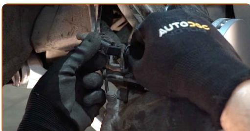
**22** Nainštalujte zádržnú pružinu brzdrového strmeňa. Použite páčidlo.
