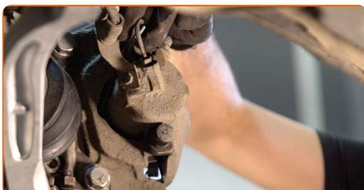
**21** Zapojte snímač opotrebenia brzdrových platničiek.
