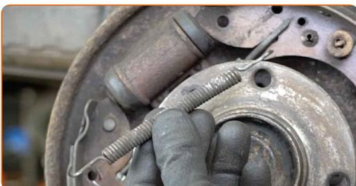
**18** Odstráňte držiaky čelustí bubnovej brzdy. Použite kliešte na brzdové pružiny.
