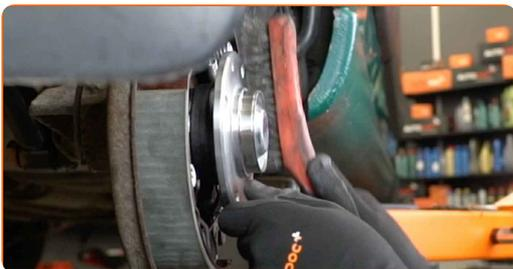
**37** Natrite kontaktný povrch. Použite keramické mazivo.
