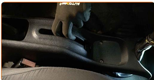
**10** Uvoľnite nastavovaciu maticu lanka parkovacej brzdy. Použite nástavec č.12. Použite ráčňový kľúč.
