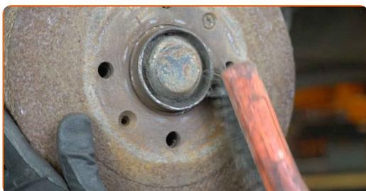
**7** Odskrutkujte upevňovacie prvky bubnovej brzdy. Použite hviezdicový Torx T30. Použite nárazový skrutkovač.
