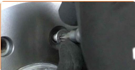
**41** Uťahnite upevňovacie prvky bubnovej brzdy. Použite hviezdicový Torx T30. Použite momentový kľúč. Uťahnite ju krútiacim momentom 10 Nm.
