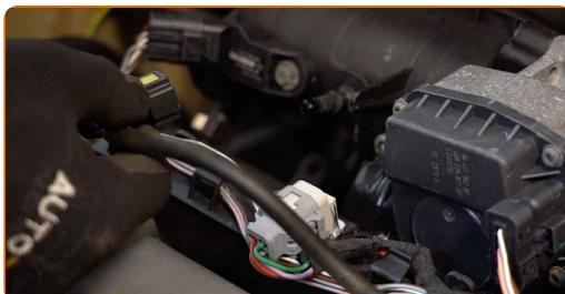
4 Odpojte hadičku ventilácie kľukovej skrine od zberača nasávacieho potrubia.
