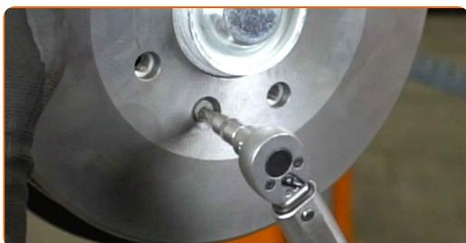
18 Natrite povrch v mieste kontaktu ráfu kolesa s bubnovou brzdou. Použite keramické mazivo.
