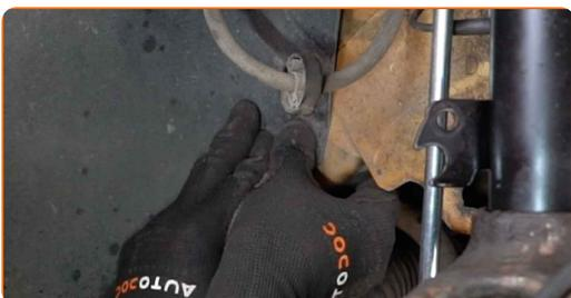
**70** Vyčistíte montážne pozície čapu tiahla riadenia. Použite drôtenú kefu. Použite sprej WD-40.
