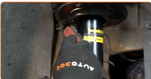
**10** Odskrutkujte upevnenie spájajúce vzperu stabilizátora k vzpere tlmiča. Použite nástavec č.17. Použite ráčňový kľúč.
