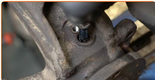
**53** Utiahnite upevňovací prvok, ktorý spája ABS senzor k hlave ložiska čapu riadenia. Použite nástavec č.13. Použite momentový kľúč. Utiahnite ju krútiacim momentom 10 Nm.
