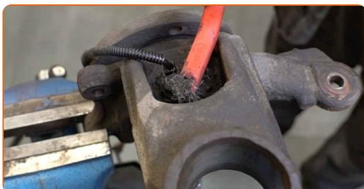
**38** Odskrutkujte upevnenie ABS snímača. Použite nástavec č.13. Použite ráčňový kľúč.
