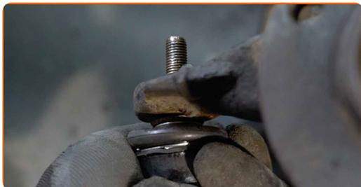
**72** Zaskrutkujte upevňovacu maticu, ktorá spája čap tiahla riadenia k hlave ložiska čapu riadenia. Použite nástavec č.17. Použite ráčňový kľúč.
