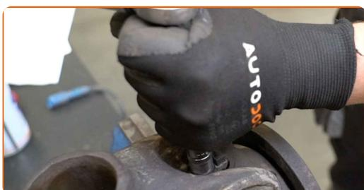
**54** Natrite montážny prvok vzpery tlmiča na hlave ložiska čapu kola. Použite drôtenú kefu. Použite sprej WD-40.
