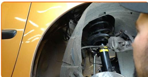
**22** Odpojte konektor ABS snímača.
