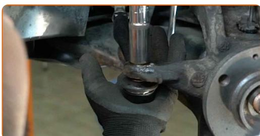
**73** Utiahnite upevňovacu maticu spájajúcu čap tiahla riadenia k hlave ložiska čapu kola. Použite nástavec č.17. Použite momentový kľúč. Utiahnite ju krútiacim momentom 35 Nm.
