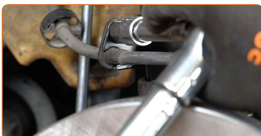
**83** Vyčistite montážne pozície vzpery stabilizátora. Použite drôtenú kefu. Použite sprej WD-40.
