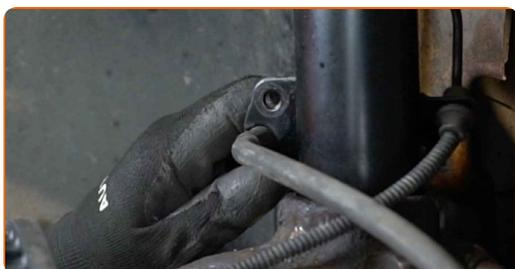
**82** Upevnite upevňovaciu svorku brzdovej hadičky k vzpere tlmiča. Použite nástavec č.13. Použite momentový kľúč. Utiahnite ju krútiacim momentom 10 Nm.
