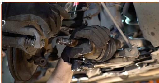
**17** Odskrutkujte upevnenie predného ramena. Použite hviezdicový Torx T55. Použite nástavec č.18. Použite ráčňový kľúč.
