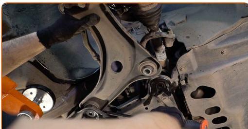
**20** Vyčistite montážne otvory a závit ramena odpruženia. Použite drôtenú kefu. Použite sprej WD-40.
