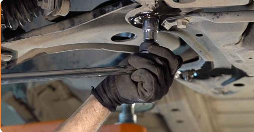
**12** Odskrutkujte upevnenie zadného ramena. Použite hviezdicový Torx T55. Použite nástavec č.18. Použite ráčňový kľúč.
