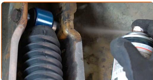
**25** Utiahnite spodné upevnenie tlmiča. Použite nástavec č.E16. Použite momentový kľúč. Utiahnite ju krútiacim momentom 100 Nm.
