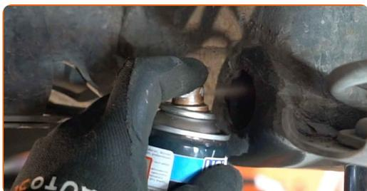
**30** Natrite povrch, kde je brzdový kotúč v kontakte s ráfikom kola. Použite medené mazivo.
