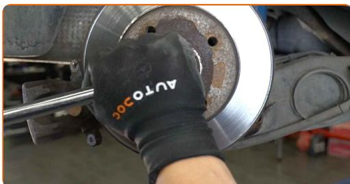
**19** Odstráňte brzdrový kotúč, ktorý je v jednej zostave s ložiskom náboja kolesa. Použite sťahovač s klzným kladivom na náboj kolesa.
