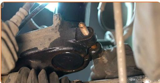
**57** Nainštalujte a utiahnite novú skrutku hlavy ložiska čapu.
