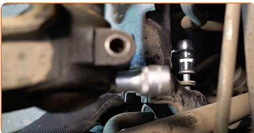
**21** Vyčistite upevnenie spájajúce guľový čap a hlavu ložiska čapu. Použite drôtenú kefu. Použite sprej WD-40.
