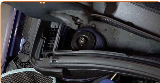
**5** Vyčistíte upevňovacie prvky vrchného ložiska vzpery tlmiča. Použijete drôtenú kefu. Použijete sprej WD-40.
