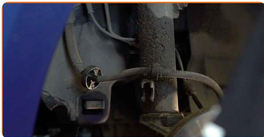
**14** Vyčistite upevňovacie prvky vzpery tlmiča. Použite drôtenú kefu. Použite sprej WD-40.
