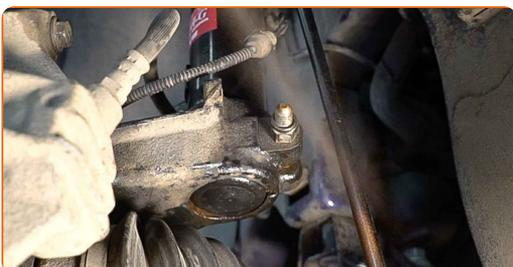
**69** Vyčistite montážny otvor disku kola. Použite drôtenú kefu. Natrite kontaktný povrch. Použite medené mazivo.
