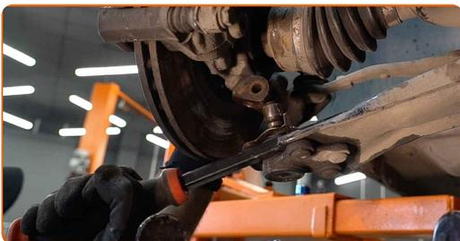
**55** Podprite rameno. Použite zdvihák s hydraulickými prevodmi.
