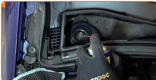
**6** Uvoľníte vrchný upevňovací prvok ložiska vzpery tlmiča. Použijete nástavec č.21. Použijete imbusový kľúč č. H7. Použijete ráčňový kľúč.
