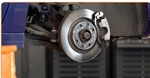
**13** Odpojte vodiče a brzdovú hadičku od svorky na vzperu tlmiča.
