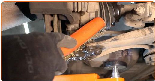
**22** Odskrutkujte upevnenie guľového čapu a tiahla riadenia. Použite nástavec č.E8. Použite nástavec č.18. Použite ráčňový kľúč.
