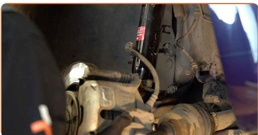
**50** Vyčistite drážky homokinetického kĺbu hnacieho hriadeľa. Použite drôtenú kefu. Použite sprej WD-40.
