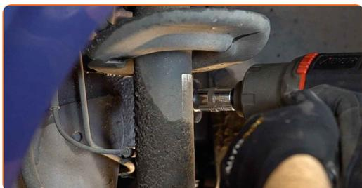
**16** Vyčistite upevňovacie prvky spájajúce vzperu tlmiča a hlavu ložiska čapu kola. Použite drôtenú kefu. Použite sprej WD-40.
