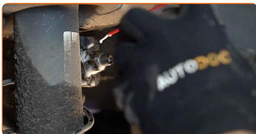
**15** Odskrutkujte maticu a odstráňte tyčku stabilizátora zo vzpery tlmiča. Použite nástavec č.16.
