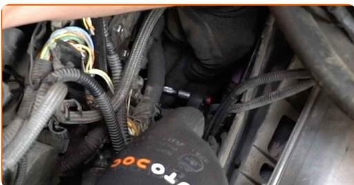
**34** Odskrutkujte montážny kolík krytu termostatu. Použite nástavec č.E5. Použite ráčňový kľúč.
