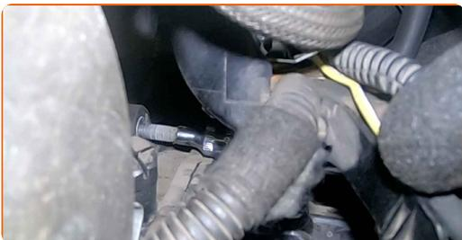
**35** Odpojte sponu hornej hadičky chladiacej kvapaliny. Použite okrúhle kliešte.
