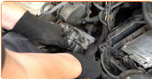
**37** Vyčistite montážnu pozíciu krytu termostatu. Použite škrabku na tmel. Použite viacúčelový čistiaci sprej.
