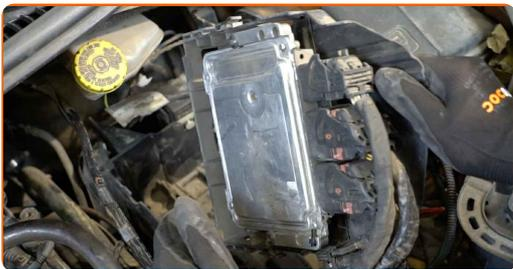
**11** Odstráňte kryt káblového zväzku motora.
