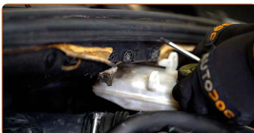
5 Odskrutkujte svorku a upevňovacie prvky na prívodnej rúrke vzduchového filtra. Použite kombinačný kľúč č.7.
