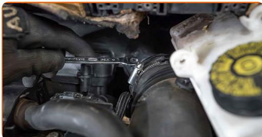
6 Uvoľnite upevňovacie skrutky krytu vzduchového filtra (3 kusy). Použite hviezdicový Torx T25. Použite ráčňový kľúč.
