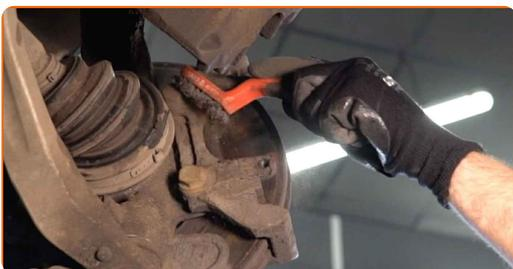
**12** Odskrutkujte upevnenie svorky brzdového strmeňa. Použite hviezdicový Torx T55. Použite ráčňový kľúč.
