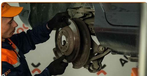
**28** Upevnite upevnenie brzdového kotúča. Použijte hviezdicový Torx T30. Použijte momentový klíč. Utiahnite ju krútiacim momentom 9 Nm.
