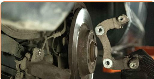
**14** Vyčistite upevňovacie prvky brzdového kotúča. Použite drôtenú kefu. Použite sprej WD-40.
