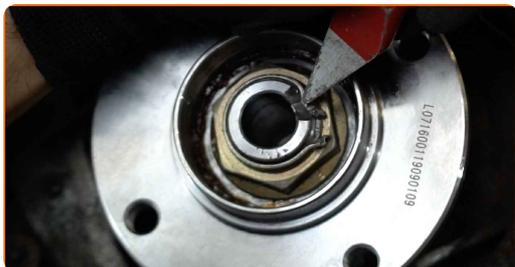
**17** Aplikujte špeciálne mazivo na montážny otvor zostavy ložiska. Použijte medené mazivo.
