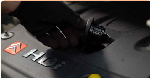
4 Odskrutujte olejový filter. Použite nástavec 74/76-15F.
