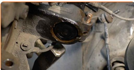
**56** Zaskrutkujte upevňovací prvok, ktorý spája tlmič k hlave ložiska čapu. Použite nástavec č.16.
