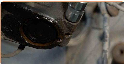
**57** Vyčistite drážky homokinetického kĺbu hnacieho hriadeľa. Použite drôtenú kefu. Použite sprej WD-40.
