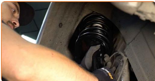
53 Zaskrutkujte vrchné upevnenie uloženia vzpery tlmiča. Neuťahujte ho.
