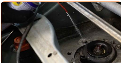
**9** Uvoľnite vrchný upevňovací prvok ložiska vzpery tmiča. Použite nástavec č.14. Použite ráčňový kľúč.
