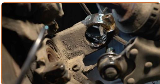
**34** Odskrutkujte upevňovacie prvky na vrchnej strane uloženia vzpery tlmiča. Použite nástavec č.14.
