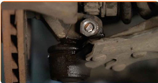
**63** Utiahnite upevnenie guľového čapu. Použite nástavec č.17. Použite kombinačný kľúč č.17. Použite momentový kľúč. Utiahnite ju krútiacim momentom 44 Nm.
