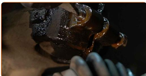
**31** Uvoľnite spodný upevňovací prvok spájajúci vzperu tlmiča a hlavu ložiska čapu kolesa. Použite plochý sekáč na kov. Použite kladivo.
