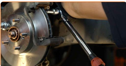
**27** Natrite piest brzdového strmeňa. Použite čistič brzd.
