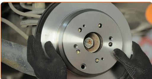
**21** Upevnite upevnenie brzdového kotúča. Použite krížový skrutkovač PH. Použite momentový kľúč. Uťahnite ju krútiacim momentom 9 Nm.
