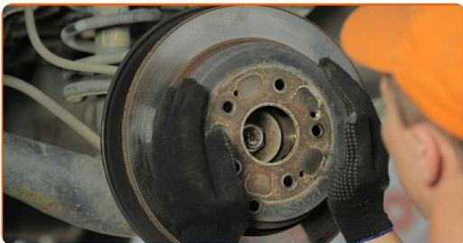
**19** Vyčistite náboj. Použite drôtenú kefu. Natrite kontaktný povrch. Použite medené mazivo.
