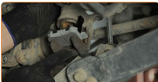
**30.1** Nainštalujte brzdový strmeň a upevnite ho.
