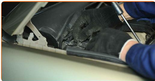
**46** Utiahnite upevňovacie prvky plastového krytu pod stierače. Použite nástavec č.8. Použite momentový kľúč. Utiahnite ju krútiacim momentom 11 Nm.
