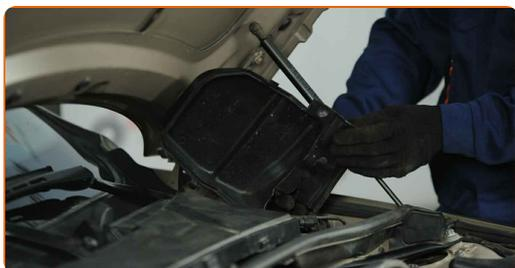
**8** Odskrutkujte upevňovacie prvky plastového krytu pod stierače. Použite nástavec č.8. Použite ráčňový kľúč.
