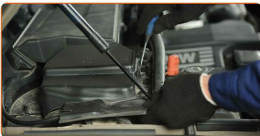
**5** Odpojte elektrické vedenie z vrchnej časti krytu mikrofiltra.
