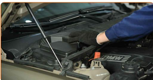
**53** Zaskrutkujte upevňovacie prvky krytu puzdra kabínového filtra. Použite nástavec č.8. Použite ráčňový kľúč.
