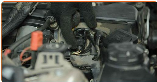
**34** Odstráňte uzáver olejového systému.
