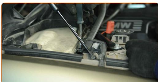
**47** Pripojte elektrické vedenie k vrchnej časti krytu mikrofiltra.
