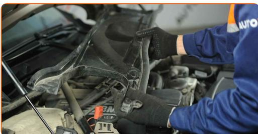
**14** Odskrutkujte upevňovacie prvky rozperných tyčí. Použite nástavec č.E14. Použite ráčňový kľúč.
