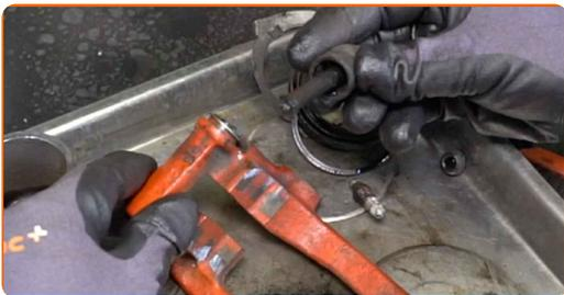
**35** Vyčistite vodiace kolíky a ich montážne pozície na držiaku brzdového strmeňa. Použite drôtenú kefu. Použite nylonovú čistiacu kefu. Použite viacúčelový čistiaci sprej.
