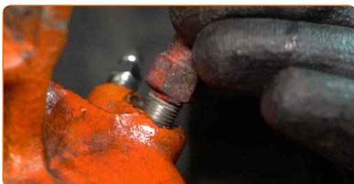
**51** Nainštalujte brzdový strmeň a upevnite ho.
