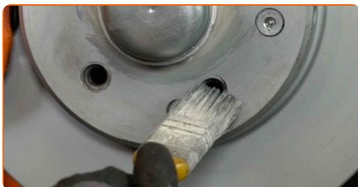
**68** Vyčistite povrch brzdového kotúča. Použite čistič brzd.
