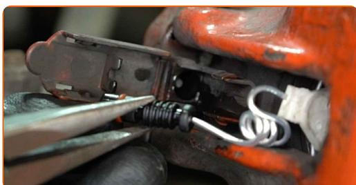
**9** Vyčistite upevňovací prvok konektora snímača opotrebenia brzdovej platničky. Použite drôtenú kefu. Použite sprej WD-40.
