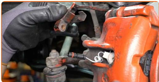
**13** Vyčistite montážnu pozíciu brzdovej hadičky na brzdovom strmeni. Použite drôtenú kefu. Použite sprej WD-40.
