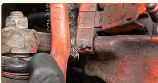
**10** Odskrutkujte upevňovací prvok konektora snímača opotrebenia brzdovej platničky. Použite kombinačný kľúč č.10.
