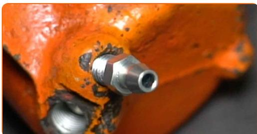
**45** Vyčistite oblasť, kde sa spája brzdová hadička k strmeňu. Použite drôtenú kefu. Použite viacúčelový čistiaci sprej.
