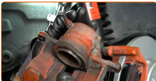
**21** Odskrutkujte brzdovú hadičku od brzdového strmeňa.
