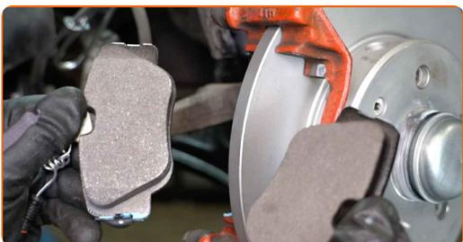
**23** Vyčistite upevňovacie prvky držiaka brzdového strmeňa. Použite drôtenú kefu. Použite sprej WD-40.
