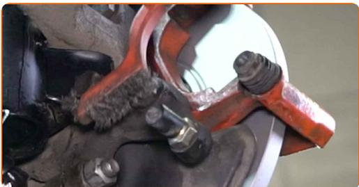
**24** Odskrutkujte upevňovacie prvky držiaka brzdového strmeňa. Použite kombinačný kľúč č.19.
