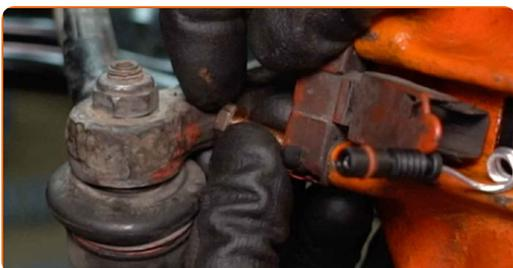
**64** Zaskrutkujte upevňovací prvok konektora snímača opotrebenia brzdovej platničky. Použite kombinačný kľúč č.10.
