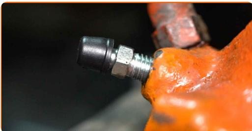
**62** Nainštalujte konektor snímača opotrebenia brzdovej platničky.
