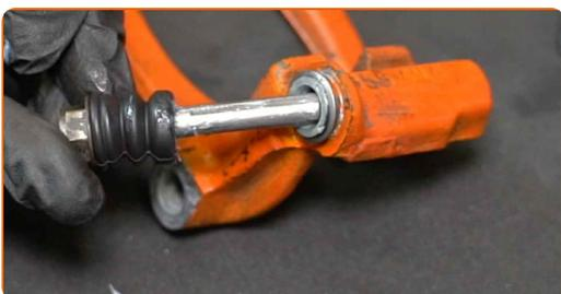
**42** Namažte vodiace závlačky brzdového strmeňa. Použite mazivo na vodiace závlačky brzdového strmeňa.
