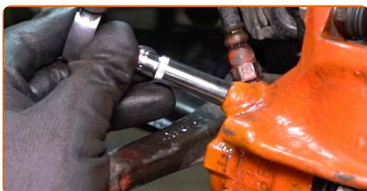
**61** Pripevnite odvzdušňovací skrutku brzdového strmeňa.
