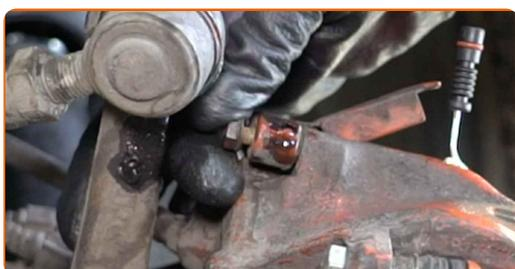
**12** Odpojte konektor snímača opotrebenia brzdovej platničky.
