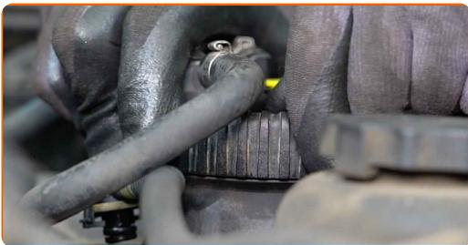
**15** Utiahnite upevňovacie prvky krytu uloženia palivového filtra. Použite univerzálny sťahovač. Použite momentový kľúč. Utiahnite ju krútiacim momentom 35 Nm.
