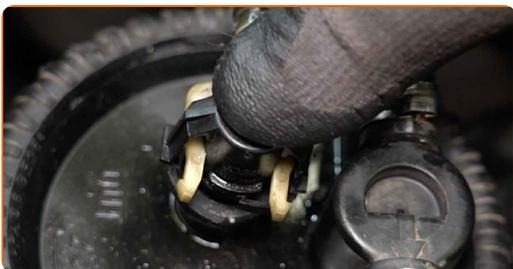
**17** Rúrku palivového filtra zabezpečte pomocou poistnej spony.
