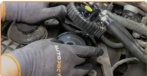
**14** Nainštalujte a upevnite uzáver krytu palivového filtra.
