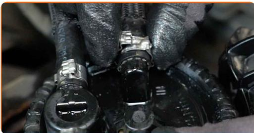
**22** Utiahnite upevňovaciu svorku rúrky palivového filtra. Použite hadicové kliešte Clic-R.
