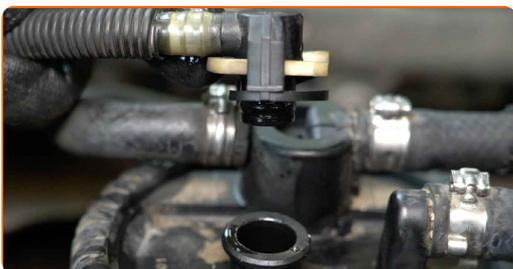
6 Odskrutkujte upevňovacie prvky krytu uloženia palivového filtra. Použite univerzálny sťahovač.
