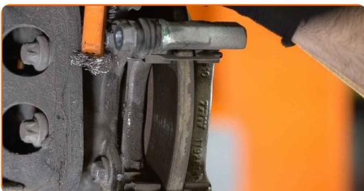
**12** Odskrutkujte upevnenie svorky brzdového strmeňa. Použite kombinačný kľúč č.13.
