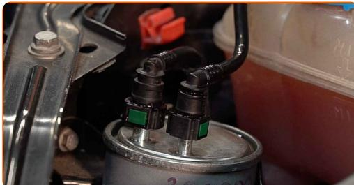
**4** Stlačte držiaky a odpojte palivové potrubie od krytu palivového filtra. Použite kliešte na palivové potrubie.
