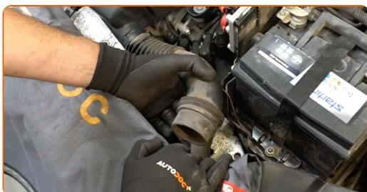
**4** Uvoľnite upevňovacie skrutky krytu vzduchového filtra. Použite nástavec č.10. Použite ráčňový kľúč.
