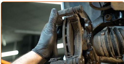
**16** Vyčistite upevňovacie prvky brzdového kotúča. Použite drôtenú kefu. Použite sprej WD-40.
