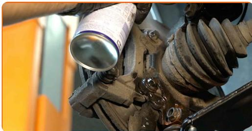
**14** Odsrutkujte upevnenie svorky brzdového strmeňa. Použite nástavec č.E18. Použite vratidlo.
