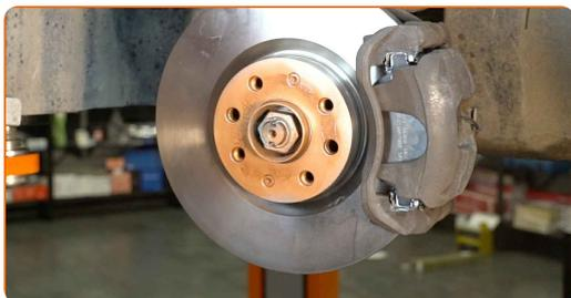
**31** Vyčistite povrch brzdového kotúča. Použite čistič brzd.
