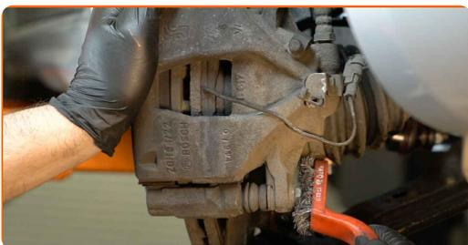
**9** Odskrutkujte upevnenie brzdového strmeňa. Použite kombinačný kľúč č.13
