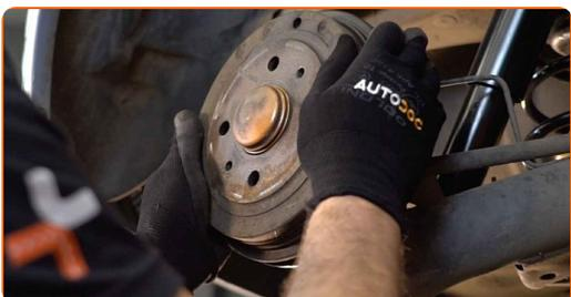
**18** Uťahnite upevňovacie prvky brzdového bubna. Použite nástavec č.12. Použite momentový kľúč. Uťahnite ju krútiacim momentom 15 Nm.
