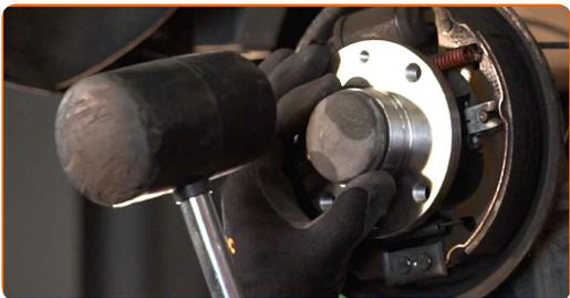
**16** Natrite náboj v mieste kontaktu s brzdovým kotúčom. Použite medené mazivo.
