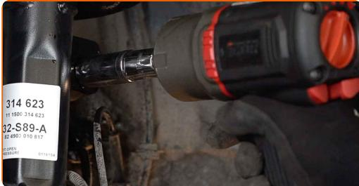
**9** Odskrutkujte a odstráňte upevňovacie prvky krytu oblúku kolesa. Použite nástavec č.10. Použite ráčňový kľúč. Použite krížový skrutkovač PH.
