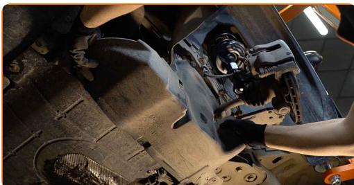
**11** Vyčistite upevňovacie prvky vzpery stabilizátora. Použite drôtenú kefu. Použite sprej WD-40.
