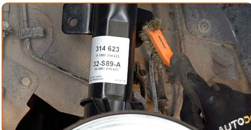
**8** Odskrutkujte upevnenie spájajúce vzperu stabilizátora k vzperu tlmiča. Použite nástavec č.17. Použite ráčňový kľúč.
