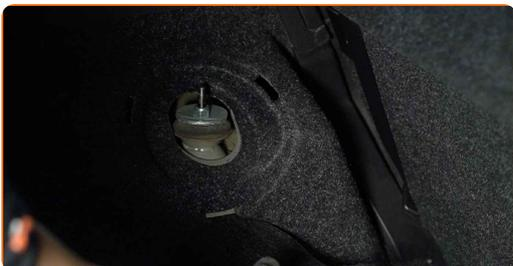
**3** Uvoľnite horný upevňovací prvok tlmiča. Použite kombinačný kľúč č.17. Použite upínacie kliešte.
