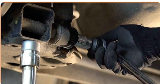
**12** Odskrutkujte vrchné upevnenie tlmiča.
