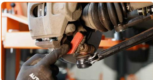
22 Odskrutkujte upevnenie guľového čapu a tiahla riadenia. Použite nástavec č.15. Použite hviezdicový Torx T50. Použite ráčňový kľúč.
