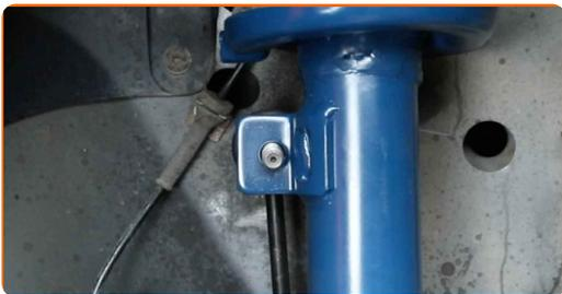
**61** Utiahnite upevňovací prvok vzpery stabilizátora. Použite nástavec č.17. Použite ráčňový kľúč.
