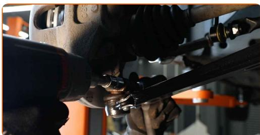
**58** Upevnite brzdovú hadičku na vzperu.
