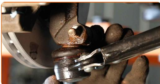
**57** Zaskrutkujte upevňovacie prvky guľového čapu. Použite nástavec č.15. Použite hviezdicový Torx T50. Použite ráčňový kľúč.
