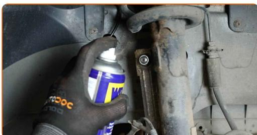
**11** Odskrutkujte upevnenie spájajúce vzperu stabilizátora k vzpere tlmiča. Použite nástavec č.17. Použite ráčňový kľúč.
