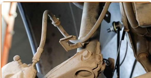
**15** Vyčistite upevňovacie prvky spájajúce vzperu tlmiča a hlavu ložiska čapu kolesa. Použite drôtenú kefu. Použite sprej WD-40.
