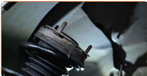
**42** Zaskrutkujte vrchné upevnenie uloženia vzpery tlmiča. Neuťahujte ho.
