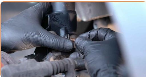
49 Zapojte upevnenie brzdovej hadičky k vzpere tlmiča.
