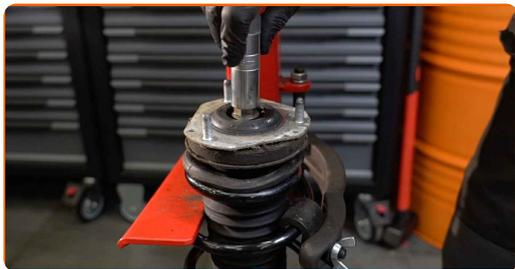
**36** Upevnite maticu piestu vzpery tlmiča. Použite imbusový kľúč č. H6. Použite nástavec č.18. Použite momentový kľúč. Uťahnite ju krútiacim momentom 48 Nm.
