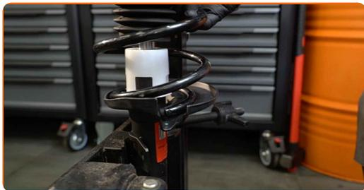
**40** Natrite montážne pozície tlmiča pruženia. Použite drôtenú kefu. Použite sprej WD-40.
