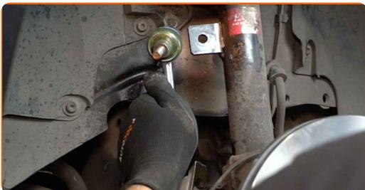
**16** Odpojte brzdovú hadičku zo vzpery tlmiča. Použite páčidlo.
