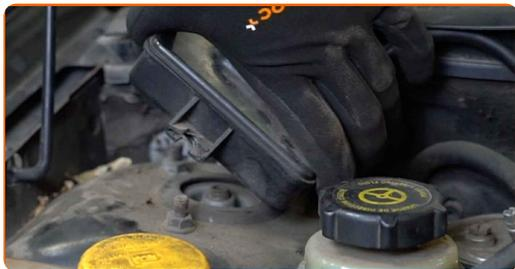
**4** Vyčistite upevňovacie prvky vrchného ložiska tlmíča. Použite drôtenú kefu. Použite sprej WD-40.
