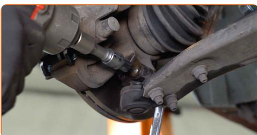
**24** Uvoľnite upevnenie spájajúce guľový čap a hlavu ložiska čapu. Použite plochý sekáč na kov. Použite kladivo.
