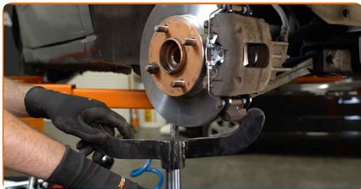
**29** Uvoľnite spodný upevňovací prvok spájajúci vzperu tlmiča a hlavu ložiska čapu kola. Použite špeciálny nástavec na odstránenie tlmiča. Použite ráčňový kľúč.
