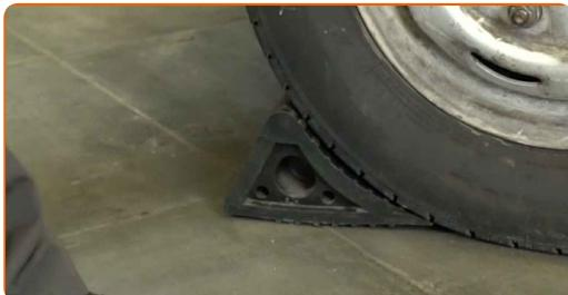
4 Uvoľnite matice kolies. Použite úderovú rázovú hlavicu na matice kolies 21 mm. Použite otočný kolík.
