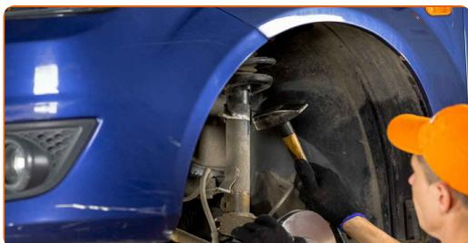
**40** Podoprite rameno. Použite zdvihák s hydraulickými prevodmi.
