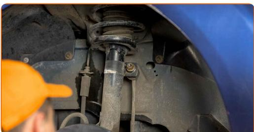
47 Utiahnite upevnenie spájajúce vzperu stabilizátora k vzpere tlmiča. Použite kombinačný kľúč č.15 Použite imbusový kľúč č. H6. Použite momentový kľúč. Utiahnite ju krútiacim momentom 48 Nm.
