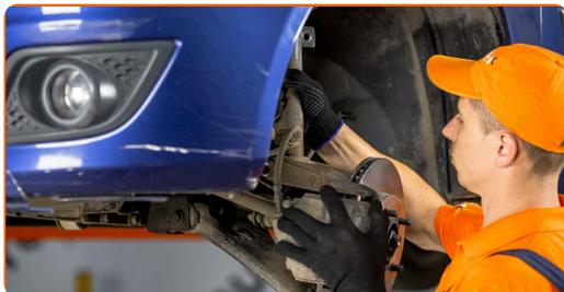
**39** Upevnite vzpery tlmíča k tiahu riadenia. Použite kladivo. Použite páčidlo.
