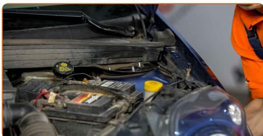
34 Utiahnite vrchné upevnenie uloženia vzpery tlmiča. Použite kombinačný kľúč č.13 Použite momentový kľúč. Utiahnite ju krútiacim momentom 30 Nm.
