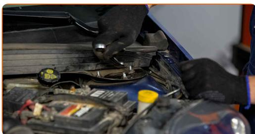
35 Natrite upevnenia ložiska vzpery tlmiča. Použite medené mazivo.
