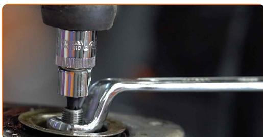
**30** Odstráňte vrchné uloženie vzpery. Použite páčidlo.
