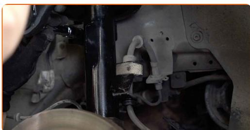
**48** Vyčistite montážny otvor disku kolesa. Použite drôtenú kefu. Natrite kontaktný povrch. Použite medené mazivo.
