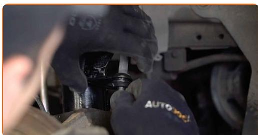
**47** Zaistite stabilizačnú tyč na vzperu zavesenia kolies. Použite nástavec č.15. Použite momentový kľúč. Uťahnite ju krútiacim momentom 48 Nm.
