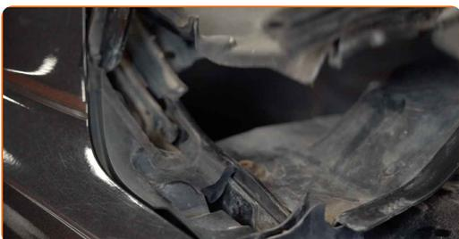
**9** Odskrutkujte upevňovací prvok spodného plastového krytu pod stierače. Použite hviezdicový Torx T30. Použite ráčňový kľúč.
