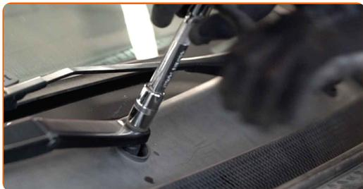
**5** Vyčistite pivotné prvky ramien stieračov. Použite sprej WD-40.
