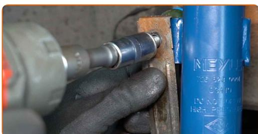
**73** Utiahnite upevnenie spájajúce vzperu stabilizátora k vzpere tlmiča. Použite nástavec č.15. Použite momentový kľúč. Utiahnite ju krútiacim momentom 50 Nm.
