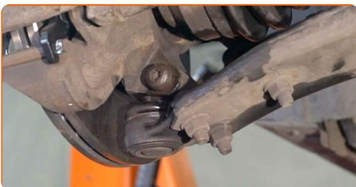
**65** Zaskrutkujte upevňovací prvok spájajúci guľový čap k hlave ložiska čapu nápravy. Použite hviezdicový Torx T50. Použite kombinačný kľúč č.15. Použite ráčňový kľúč.
