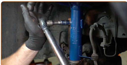
**74** Upevnite brzdovú hadičku na vzperu.
