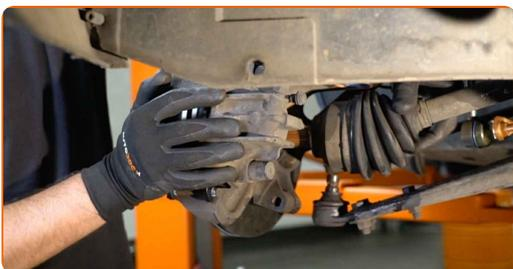
**62** Vyčistite montážnu pozíciu guľového čapu. Použite drôtenú kefu. Použite sprej WD-40.
