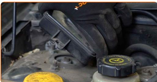
**4** Vyčistite upevňovacie prvky vrchného ložiska tlmiča. Použite drôtenú kefu. Použite sprej WD-40.
