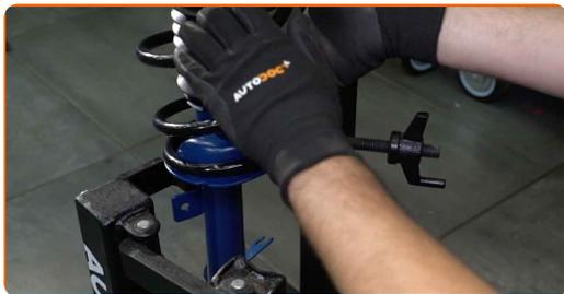
**51** Vyčistite montážne pozície vzpery tlmiča. Použite drôtenú kefu. Použite sprej WD-40.
