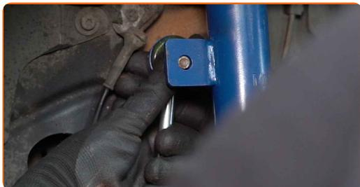
**72** Utiahnite upevňovací prvok vzpery stabilizátora. Použite kombinačný kľúč č.15. Použite nástavec č.15. Použite ráčňový kľúč.
