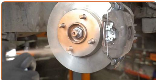
**78** Vyčistite povrch brzdového kotúča. Použite čistič brzd.
