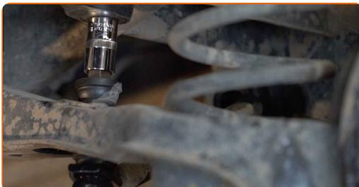
**11** Urobte si značku na krízovom nosníku a na skrutke na nastavenie náklonu. Použite plochý sekáč na kov. Použite kladivo.
