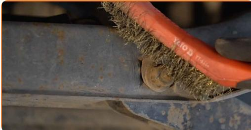
**10** Odskrutkujte upevňovacie prvky stabilizačnej tyčky. Použite kombinačný klúč č.15. Použite nástavec č.15. Použite ráčňový klúč.
