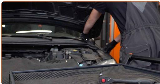
**4** Odskrutkujte upevňovacie prvky ramien stieračov. Použite nástavec č.15. Použite ráčňový kľúč.
