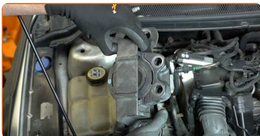
Výmena: silentblokov motora – FORD Grand C-Max (DXA/CB7, DXA/CEU). Tip od AUTODOC:
