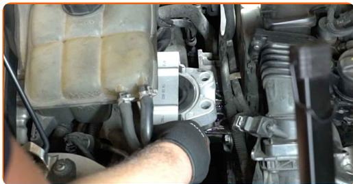
**14** Utiahnite upevňovacie skrutky uloženia motora. Použite nástavec č.E11. Použite momentový kľúč. Utiahnite ju krútiacim momentom 32 Nm.
