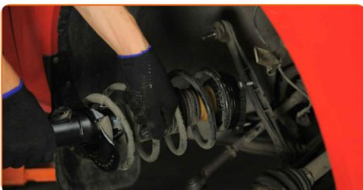
**47** Zaskrutkujte vrchné upevnenie uloženia vzpery tlmiča.
