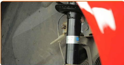
**70** Utiahnite upevnenie spájajúce vzperu stabilizátora k vzpere tlmiča. Použite kombinačný kľúč č.17 Použite imbusový kľúč č. H5. Použite momentový kľúč. Utiahnite ju krútiacim momentom 48 Nm.
