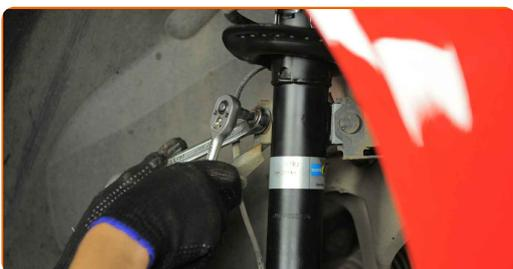
**71** Pripevnite konektor ABS snímača.
