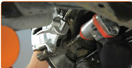
**64** Upevnite brzdovú hadičku na vzperu.
