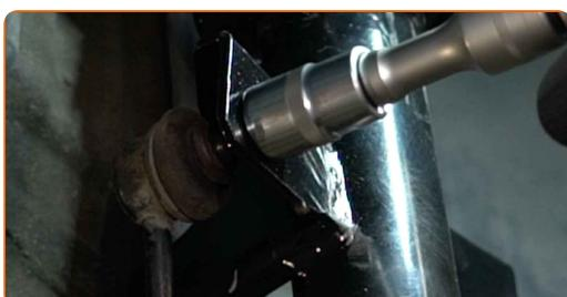
**8** Odskrutkujte upevnenie spájajúce vzperu stabilizátora k stabilizátoru. Použite kombinačný kľúč č.16. Použite kombinačný kľúč č.17.
