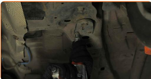
**13** Odstráňte predný upevňovací prvok ovládacieho ramena. Použite páčidlo.
