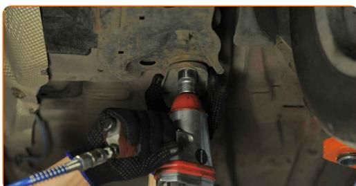
**18** Podprite rameno. Použite zdvihák s hydraulickými prevodmi.
