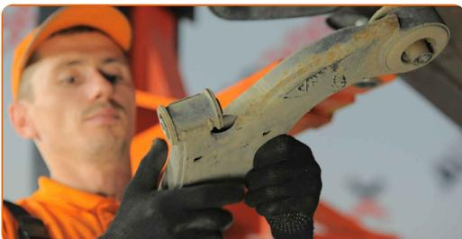
23 Vyčistíte montážne otvory a závit ramena odpruženia. Použite drôtenú kefu. Použite sprej WD-40.
