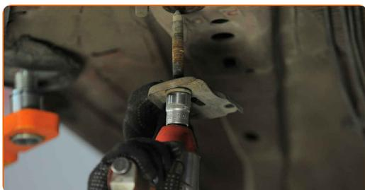
**17** Odskrutkujte upevňovací prvok svorky, ktorá spája rameno zavesenia kolies ku karosérii auta. Použite nástavec č.21. Použite ráčňový kľúč.
