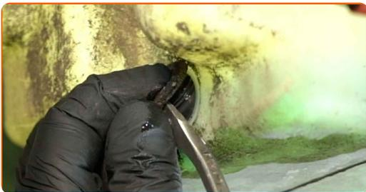
**18** Vyčistite montážnu pozíciu čerpadla ostrekovača čelného skla. Použite viacúčelový čistiaci sprej.
