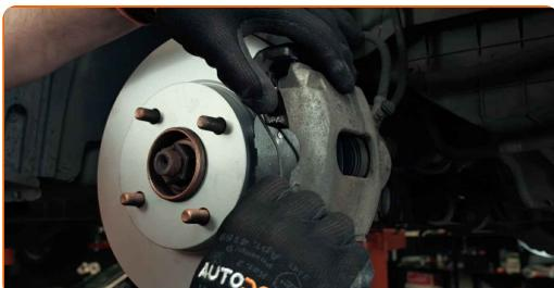
**28** Natrite povrch, kde je brzdový kotúč v kontakte s ráfikom kolesa. Použite medené mazivo.
