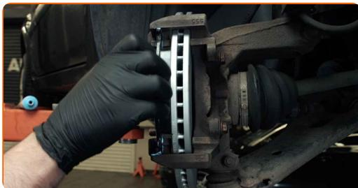
**25** Nainštalujte brzdový strmeň a upevnite ho. Použite imbusový kľúč č. H7. Použite momentový kľúč. Utiahnite ju krútiacim momentom 30 Nm.
