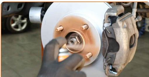
**29** Vyčistite povrch brzdového kotúča. Použite čistič bŕzd.
