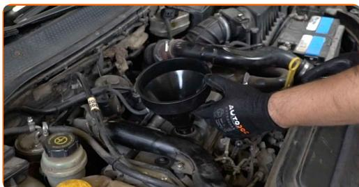
22 Nový olej nalejte do motora, a to v množstve, ktoré odporúča výrobca auta.
