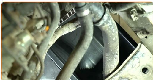
6 Odskrutkujte zátku na vypúšťanie chladiacej kvapaliny. Použite plochý skrutkovač.
