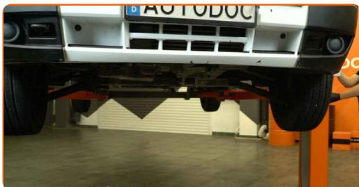
5 Pripravte si nádobu na vypúšťanie kvapaliny.
