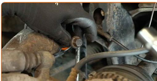
**42** Odpojte hlavu ložiska čapu kolesa od vzpery zavesenia. Použite gumové kladivo. Použite prevodový zdvihák alebo ešte jeden zdvihák vozidla.
