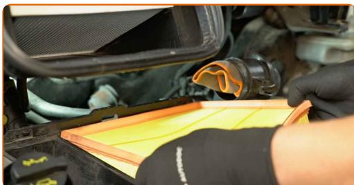
9 Odskrutkujte upevňovacie prvky krytu vzduchového filtra. Použite nástavec 10 mm. Použite ráčňový kľúč.
