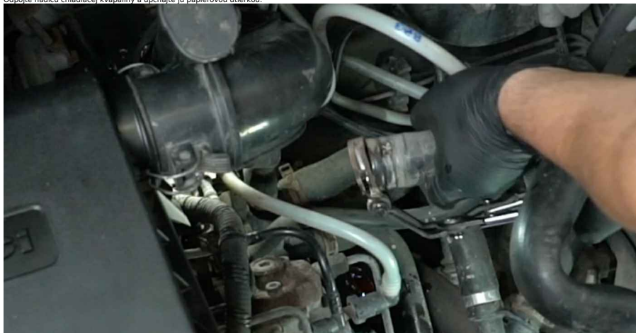
11 Vyčistite upevňovacie prvky krytu puzdra termostatu. Použite drôtenú kefu. Použite viacúčelový čistiaci sprej.
