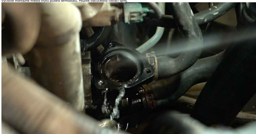
17 Nainštalujte nový termostat.
