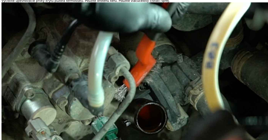
12 Odskrutkujte upevňovacie prvky krytu puzdra termostatu. Použite hviezdíkový nástavec Torx T25. Použite predĺženie nástavca univerzálneho kľuču. Použite ráčňový kľúč.
