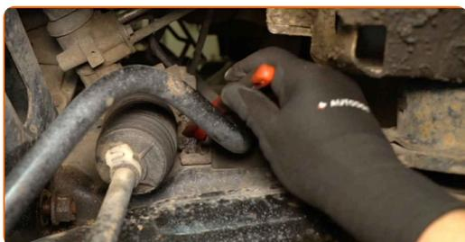
**12** Odskrutkujte upevňovacie prvky držiaka silentbloku stabilizátora. Použite nástavec 10 mm. Použite ráčňový kľúč.
