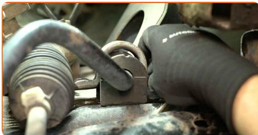
**15** Odstráňte silentblok stabilizátora.
