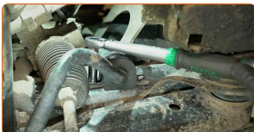
**23** Vyčistite montážne miesta tyčky stabilizátora na jednej strane nápravy. Použite drôtenú kefu. Použite viacúčelový čistiaci sprej.
